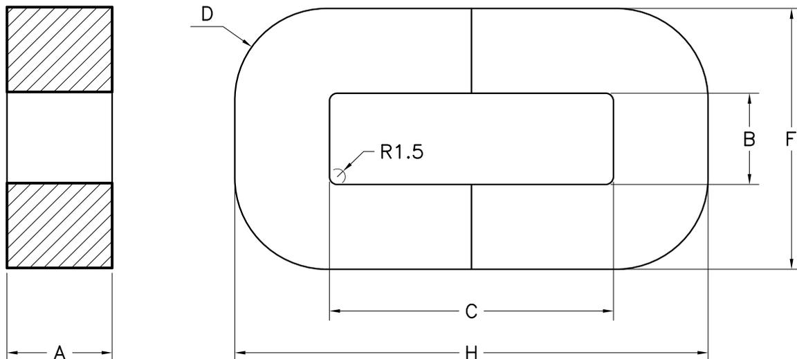
Materiale: Ferro/Silicio HiB – spessore laminato 0.27mm.
